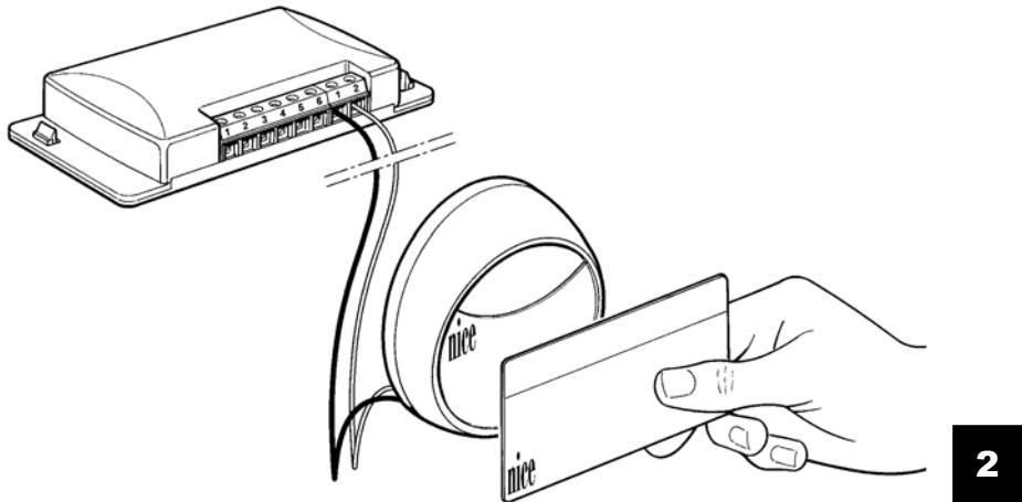
ДЕКОДЕР, используемый в обоих системах, выполняет “разумную” работу в системе, что значит, получает код КАРТЫ, посыпаемый СЧИТЫВАТЕЛЕМ или комбинацию, введенную на клавиатуре, а потом сверяет полученную информацию с имеющейся на плате памяти, чтобы удостовериться, что она действительна; если карточка действительна, она активизирует нужный выход.
